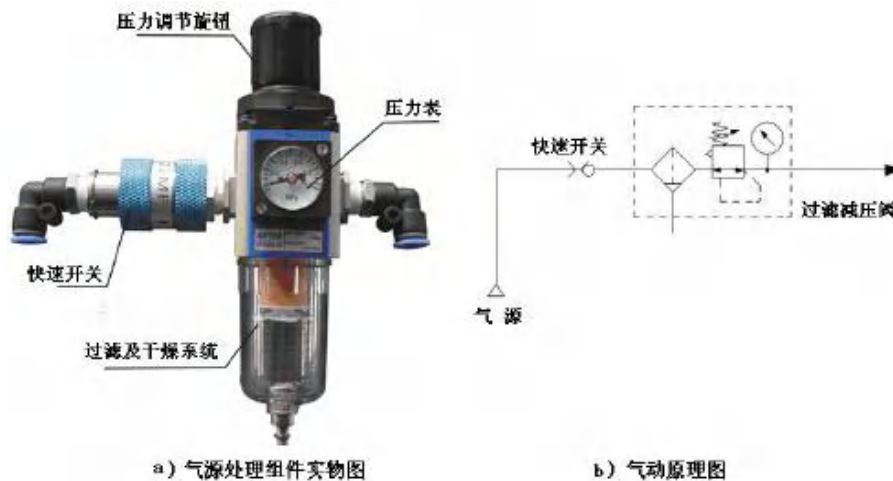
图 1-20 YL-335B 的气源处理组件
