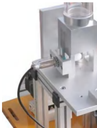
图 2-8 供料单元上的电感式传感器
